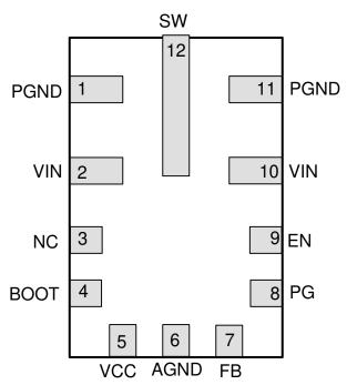
Figure 4-1. Pin Diagram
