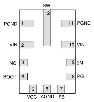
Figure 4-1. Pin Diagram
