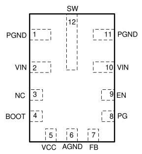
Figure 4-1. Pin Diagram
