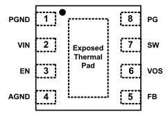
Figure 4-1. Pin Diagram
