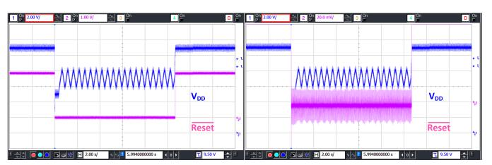
Figure 6. Volkswagen Cold-Start Test Pulse, VW80000
