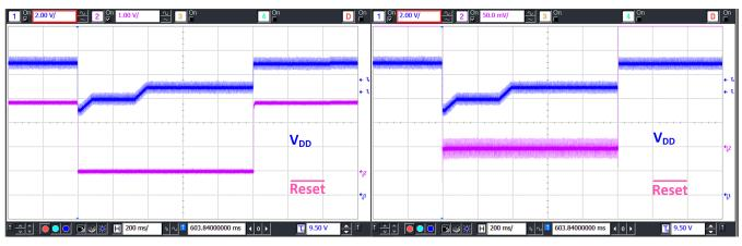
Figure 5. Volkswagen Warm-Start Test Pulse, VW80000
