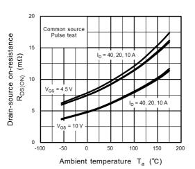
Fig. 8.9 R<sub>DS(ON)</sub> - T<sub>a</sub>
