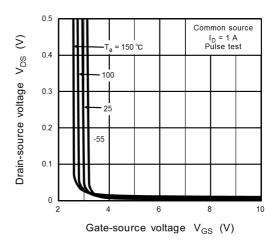
Fig. 8.6  $V_{DS} - V_{GS}$
