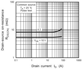
Fig. 8.8 R<sub>DS(ON)</sub> - I<sub>D</sub>
