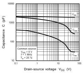
Fig. 8.13 Capacitance - V<sub>DS</sub>
