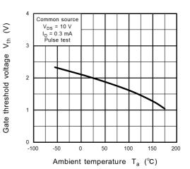
Fig. 8.12 V<sub>th</sub> - T<sub>a</sub>
